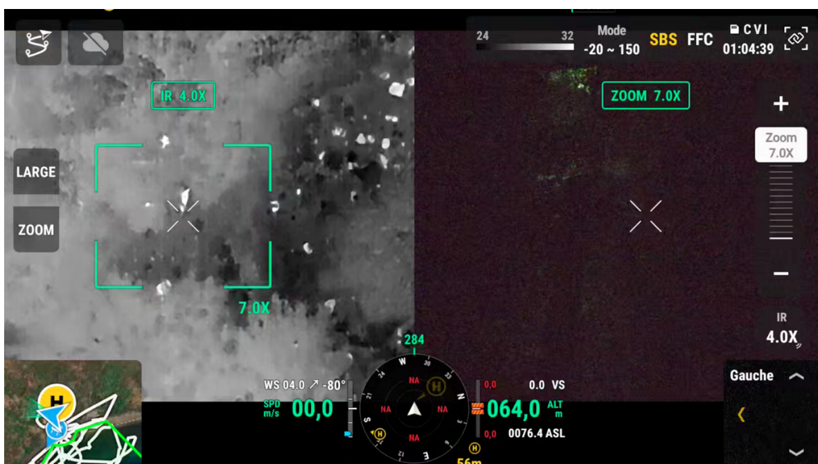
Figure 15 : la vue partagée permet de voir l'utilisation de lumière artificielle par les agents lorsque la détection thermique est complexe.
