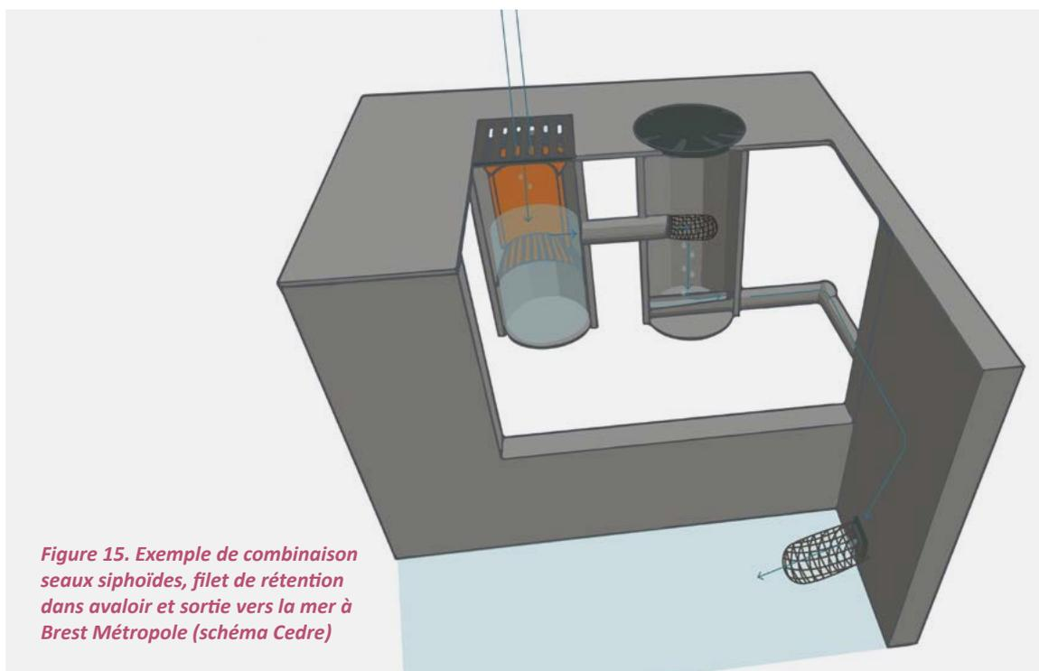
*Figure 15. Exemple de combinaison seaux siphoniques, filet de rétention dans avaloir et sortie vers la mer à Brest Métropole (schéma Cedre)*
