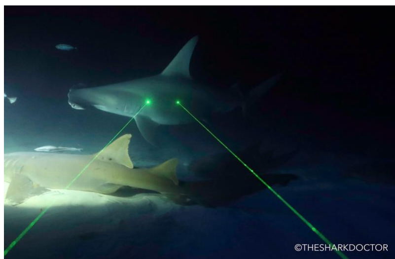
Figure 2 : Exemple d'utilisation des lasers pour mesurer la taille d'un requin marteau
