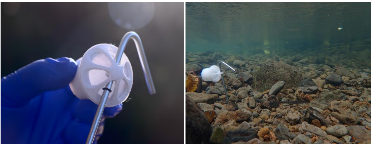
Figure 5 : Échantillonneur passif avant son immersion (à gauche) et une fois installé dans le lit du cours d'eau (à droite).
